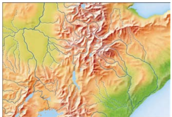
Рис. 2. Использование цвета для передачи объёмности изображения на карте с помощью: гипсометрической окраски (спектральная шкала Пойкера) (а) и цветной отмычки рельефа (б)
